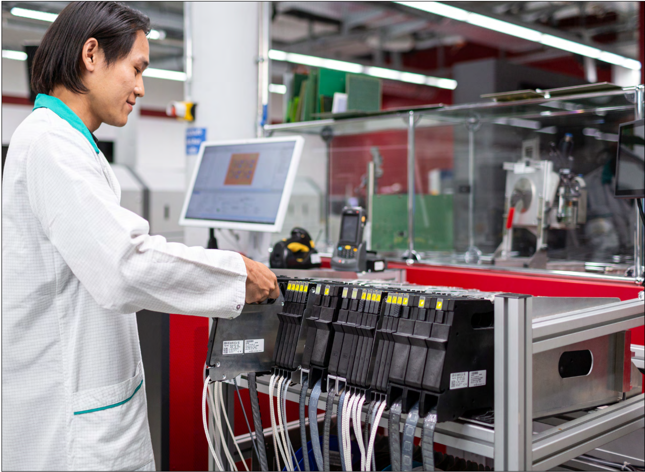
Active Feeder Rack: Hier sind gerüstete Förderer zwischengelagert, die bald wieder benötigt werden. Anhand der LED-Signale sehen Mitarbeitende sofort, welche Feeder für die nächste Rüstung benötigt werden. Ebenso wird die Zielspur der neuen Rüstung angezeigt.
