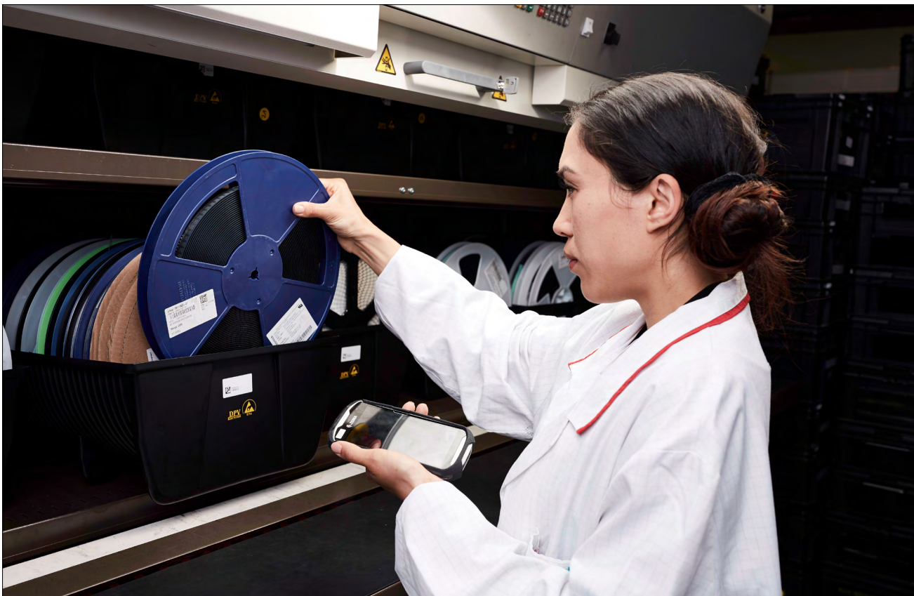
Softwareunterstützte Materialentnahme: Mitarbeitende erhalten von Factory Material Manager wegoptimierte Picklisten auf ihr Handheld und quittieren die Auslagerung durch das Scannen der UID.
