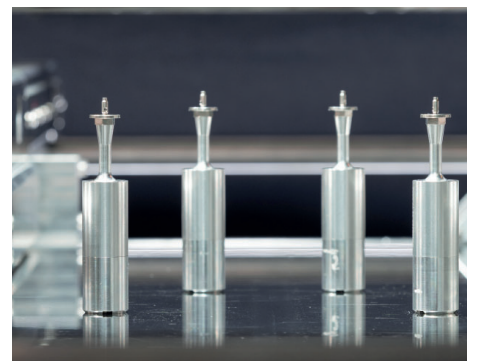
Smart Pin Support verhindert das Durchbiegen von Leiterplatten an kritischen Punkten.
