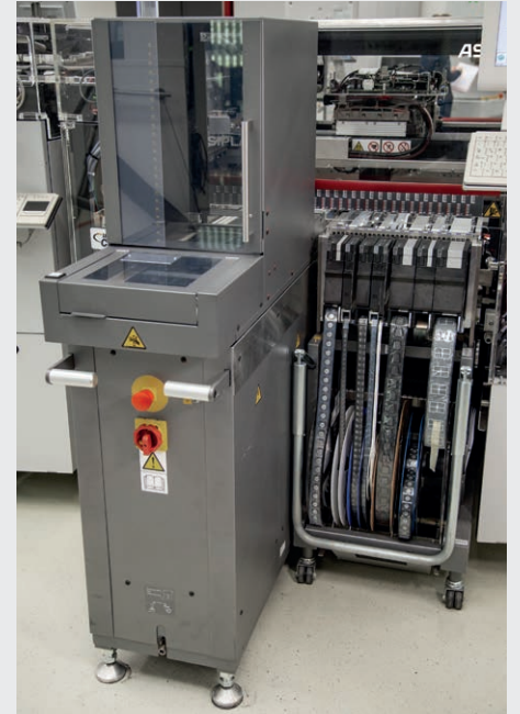
SIPLACE WPC结构紧凑、节省空间，可实现盘装料不停机连续供应。
