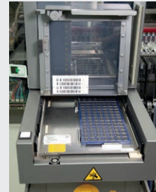
SIPLACE WPC结构紧凑、节省空间，可实现盘装料不停机连续供应。
