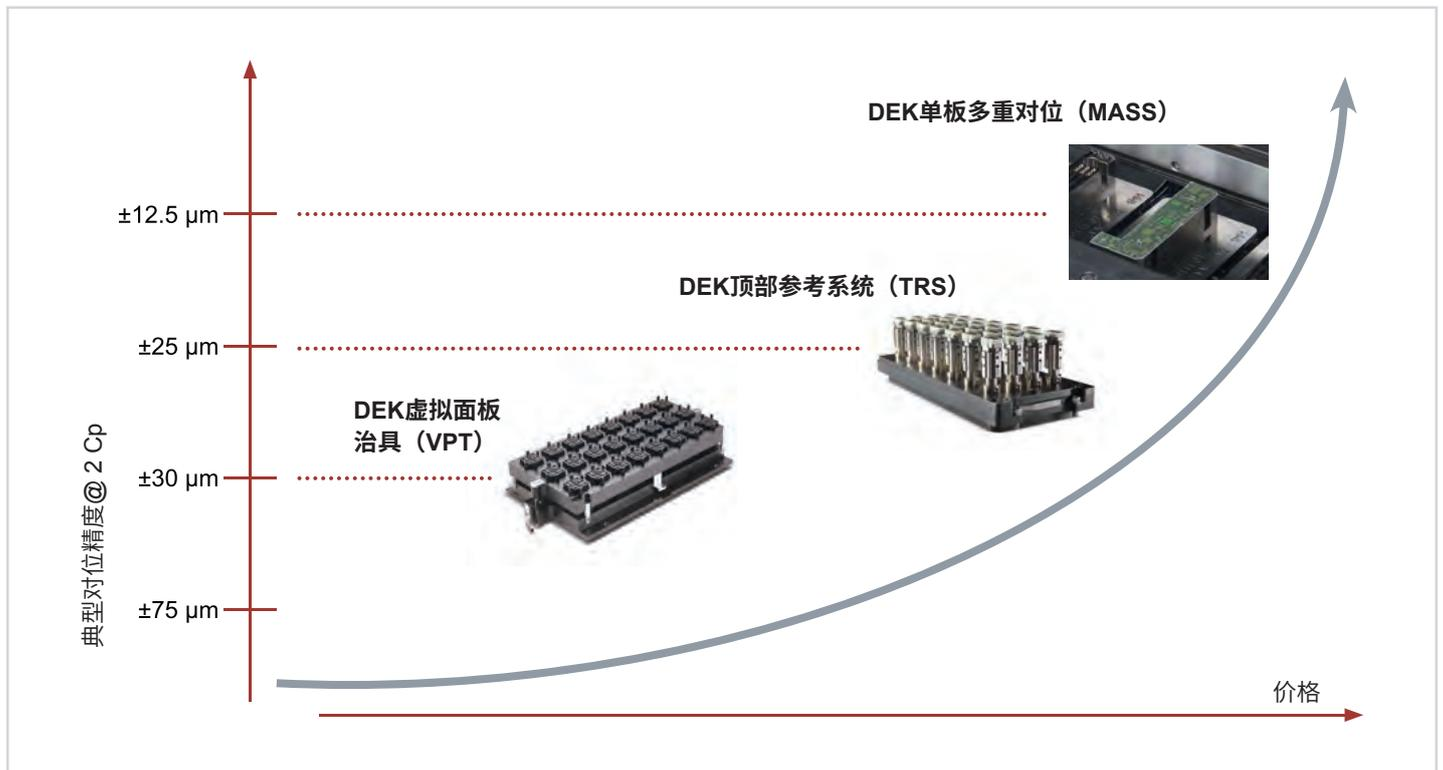
日益复杂和高密度的应用，增加了不良基板的比例。在整个工艺中移动的不良基板会有损害良率和生产力——即使这些基板没有被印刷和贴装元器件。
