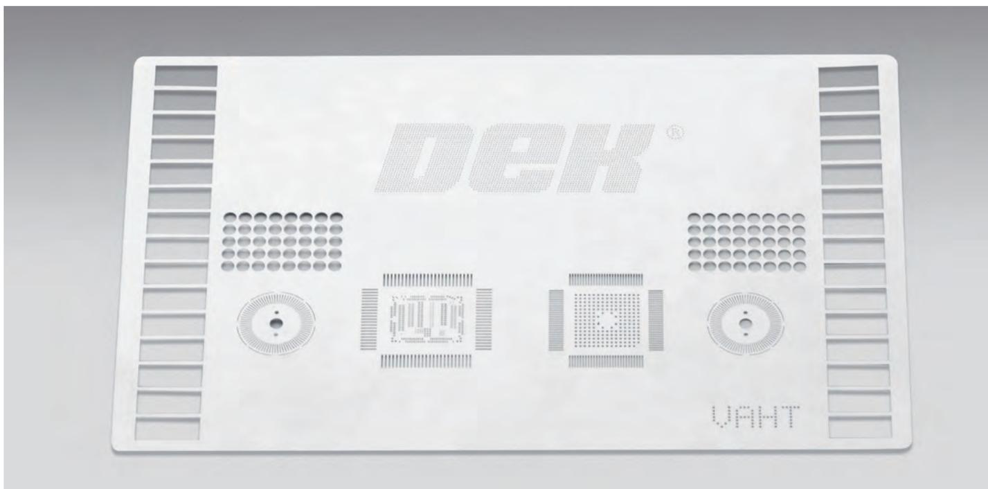
电铸钢网可以进行微调以适应特定应用。其中一种被称之为可变开孔厚度技术 (VAHT)，即在开孔周围生成密封圈以增加开孔厚度，从而增加下锡量。
