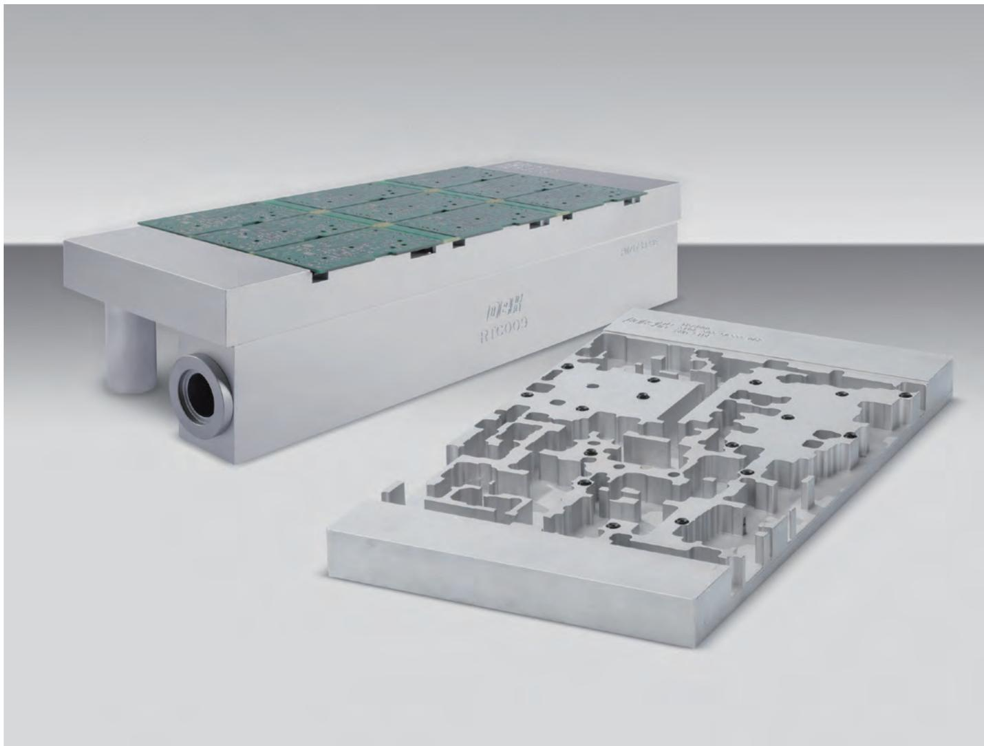
定制专用治具解决方案旨在实现最佳基板支撑和最佳印刷质量。由于加工过程中基板的任何移动或错误定位都可能导致缺陷，ASMPT采用经验证的设计概念和可靠的制造方法来防止这些问题。另外一个好处是：刮板的侧面支撑，这不仅可以显著提高钢网的使用寿命，还可以提高印刷质量。
