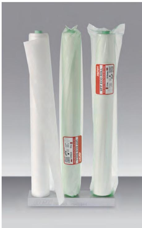
DEK UFP ECO钢网底部环保清洁布采用独特的兜状立体结构，避免了被污染的风险，它的兜状立体结构能迅速彻底地捕捉并牢牢锁住焊膏颗粒。这是与钢网底部纸质清洁产品的一个关键区别，纸质产品会使焊膏留在纸张表面，从而产生污染的可能性。因此，DEK UFP ECO环保清洁布不仅能确保钢网底部有效的清洁，还能防止污染造成的缺陷。
