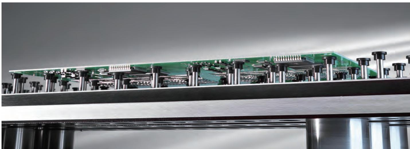
认识到比定制治具更灵活更具性价比基板支撑替代方案的需求，ASMPT开发了多次获奖的专利DEK Grid-Lok系统，该系统至今仍是业界领先的自动工具解决方案。
