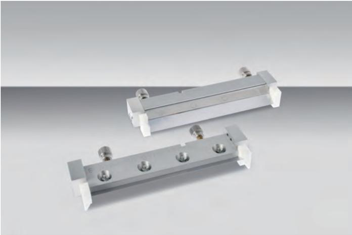
SAPD非常适合压力介于0 - 20 kg之间的SMT电路板上的锡膏印刷，它能够提升工艺控制水平并减少锡膏的浪费。挡锡块的轮廓和结构确保在印刷中锡膏不会向外溢出。这会降低锡膏的浪费（投资回报更快），并且显著减少了因处于边缘区域的锡膏变干而产生的印刷问题。最重要的是：从第一次到最后一次印刷都能保持高品质。
