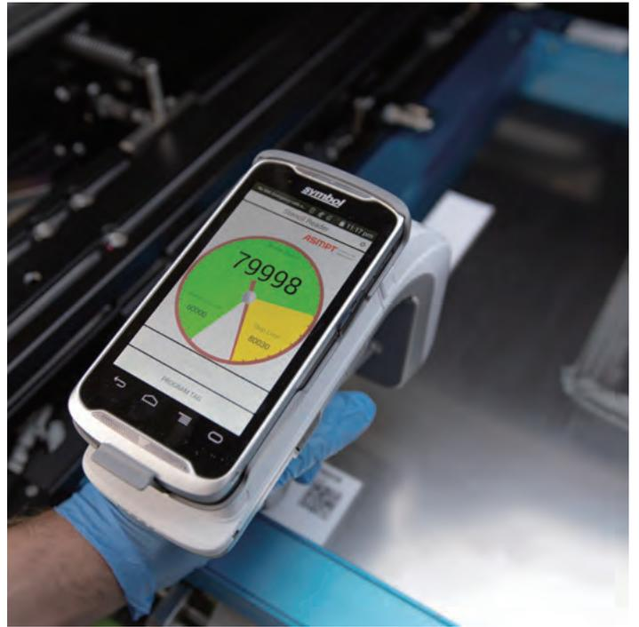
随着钢网老化，张力下降和表面磨损是正常现象，从而导致锡膏印刷工艺的品质、良率和工艺稳定性也在降低。智能钢网系统是基于RFID的解决方案，首次实现了简单、方便、无缝地监控钢网的使用寿命。
