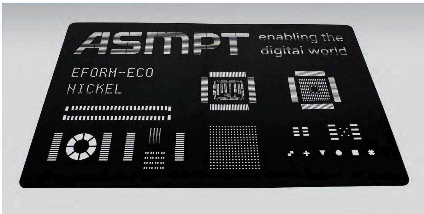
确保高品质的电子制造，关键在于了解并解决SMT常见印刷工艺缺陷。相比大多数细颗粒（FG）材料，DEK电铸ECO钢网具有光滑的孔壁。这种钢网硬度值达到500HV，具有更长的使用寿命，同时还节约了成本。
