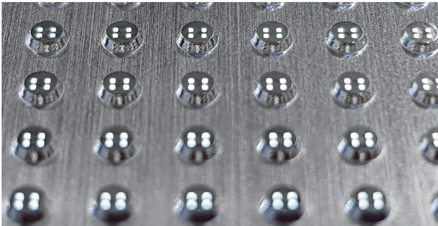
DEK电铸3D钢网是一种单厚度钢网，可对无法进行传统单次印刷的不平整表面或特征或结构进行印刷。
