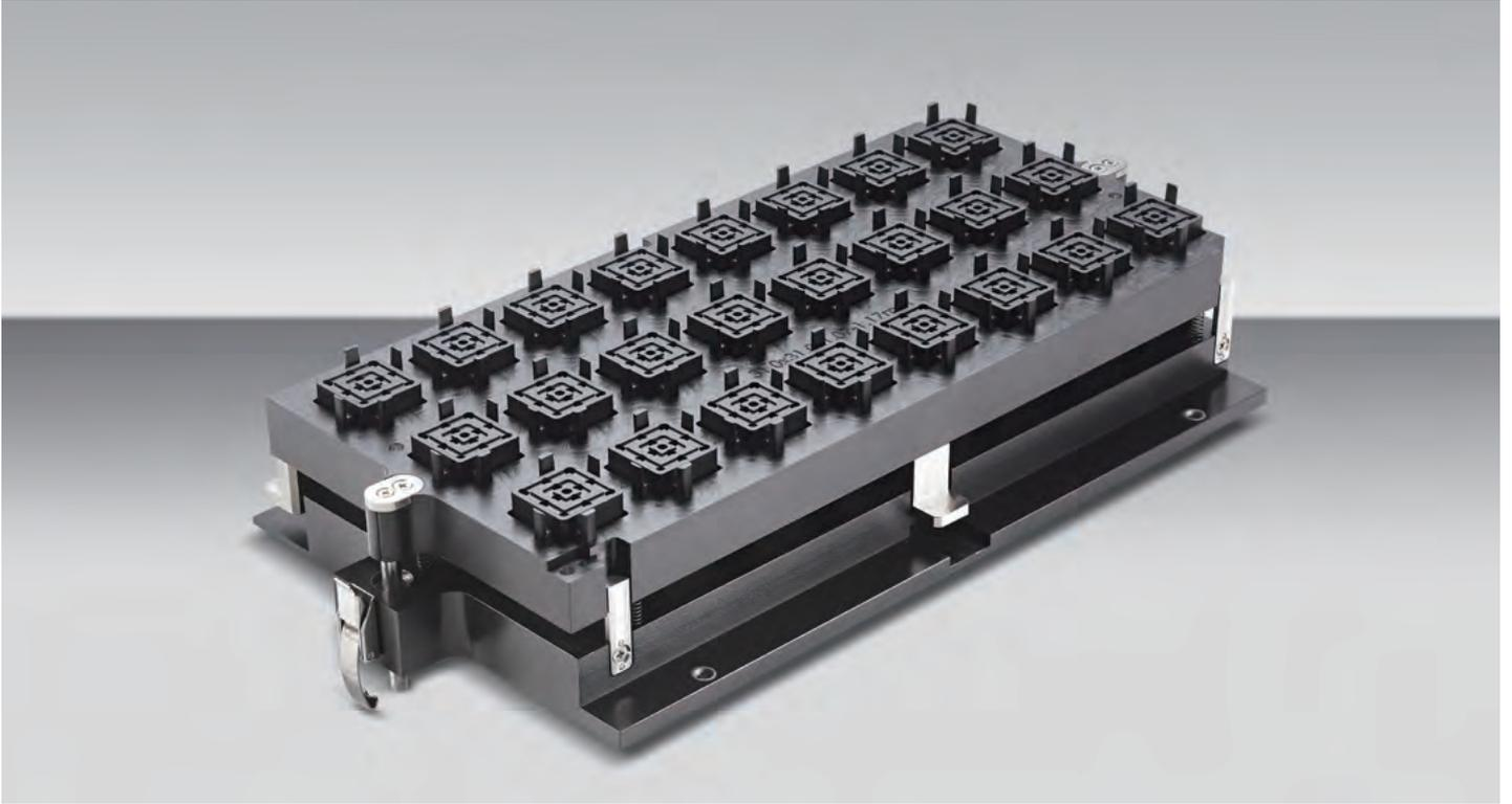
DEK虚拟面板治具 (VPT) 支持印刷机一次印刷多个单独的基板。基板放到载具中被运送给印刷机，然后从载具中被转移，通过机械居中 (定位) 并被放到环绕托盘上，在与钢网接触前创建一块“虚拟面板”，然后进行批量对位。
