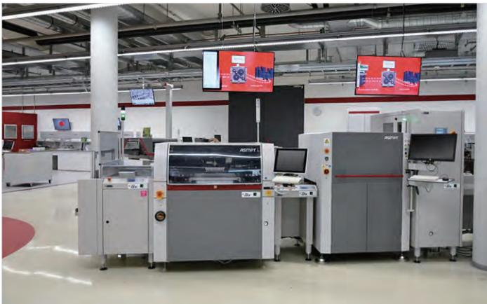
SMT应用研究中心的实际SMT生产线提供应用支持和印刷测试，包括SPI分析。
