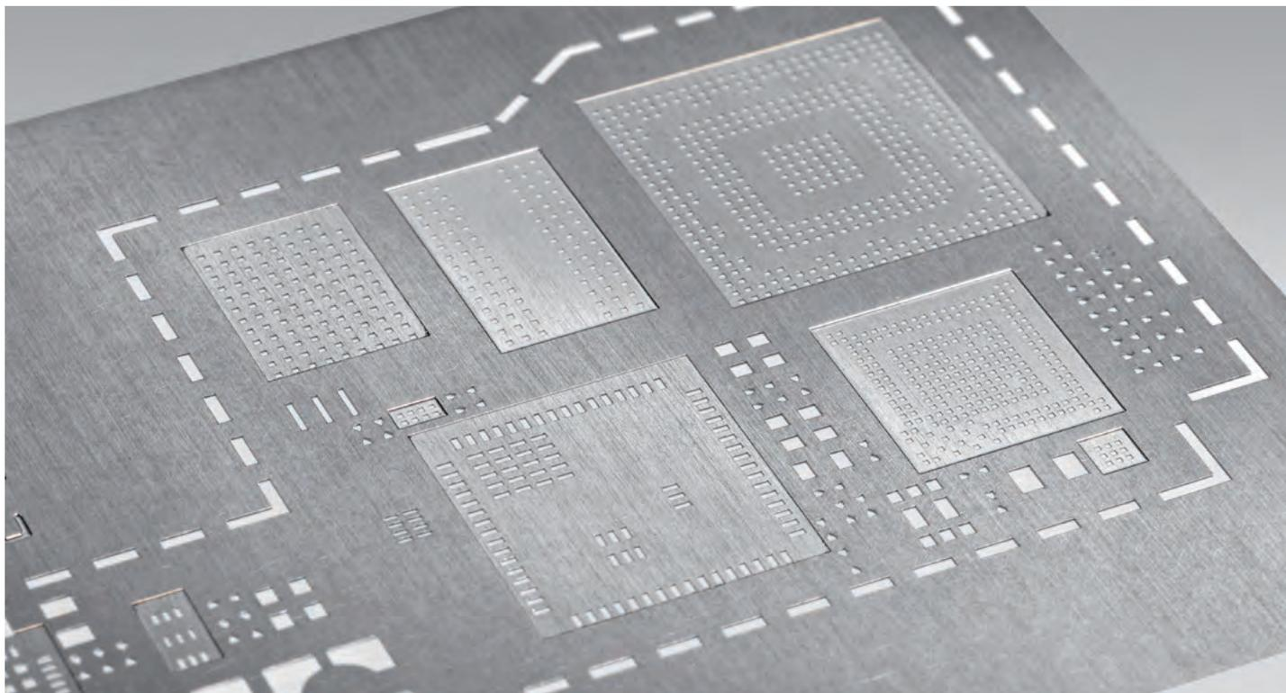
DEK阶梯钢网可选择不锈钢或镍钢片，非常适合在大面积PCB板上的细间距零件锡膏印刷。对于微型BGA, 0.3 mm QFP和微小型零件(如公制0201s)以及先进封装应用和特种锡膏的印刷效果优异。
