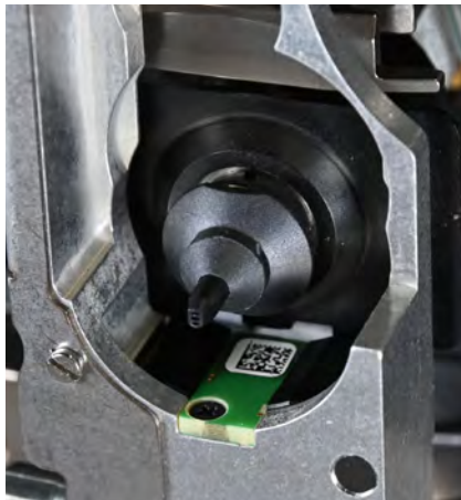
Die eindeutige Pipettenidentifikation erfolgt mithilfe von RFID-Chips in den Pipetten und RFID-Leseinheiten in den SIPLACE Bestückautomaten.
