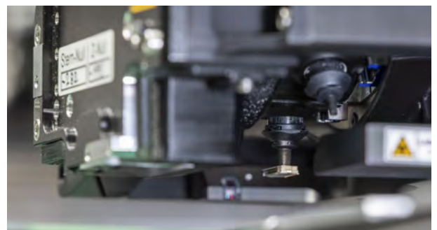
Als einzige direkte physische Schnittstelle zum Bauelement bestimmt die Pipette maßgeblich die Qualität von Aufnahme- und Bestückvorgang.
